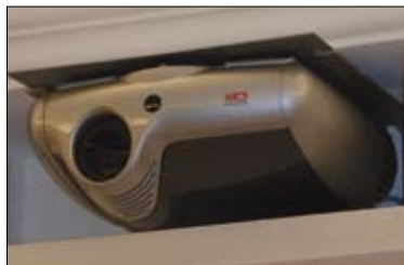
PROJEKTOR SIM2 Z TRZEMA UKŁADAMI DLP UMIESZCZONO W WENTYLOWANEJ WNĘCE.
